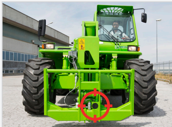
Am Anbaurahmen angebrachter Sensor
