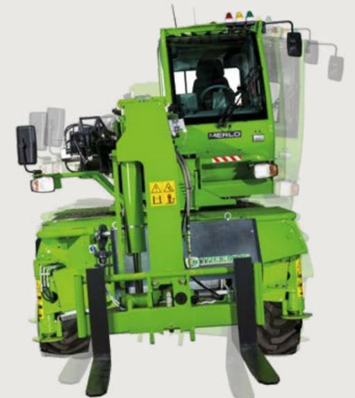
Das Sicherheitssystem ASCS (Adaptive Stability Control System) sorgt für optimierte und sichere Arbeitseinsätze. Das System passt die Geschwindigkeit und die maximale Reichweite der Bewegungen auf Grundlage von drei Betriebsparametern an:
