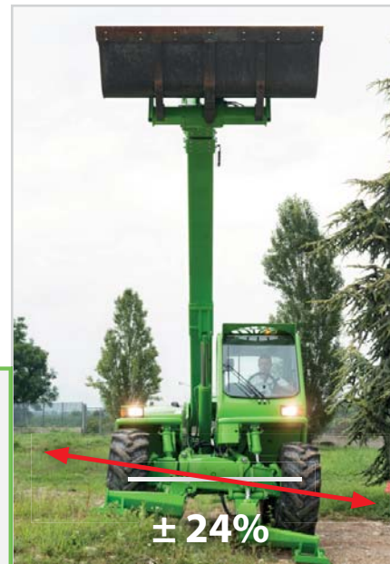
Kombinierte Wirkung von seitlicher Neigung und Abstützungen
