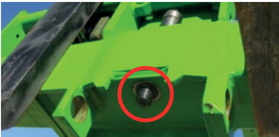
Tac-Lock: hydraulische Befestigung der Anbaugeräte direkt von der Kabine
