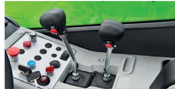
Ausführung mit 75 PS: Hebel zur Betätigung von Teleskoparm, Anbaurahmen, Werkzeugen und Seitenverschub des Teleskoparms
