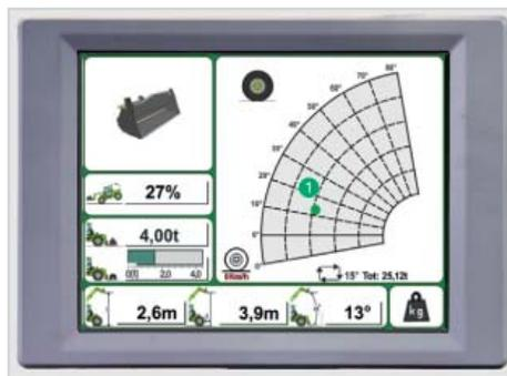
Das MCDC-System überwacht permanent die Ladevorgänge und Standsicherheit. In Abhängigkeit vom jeweiligen Anbaugerät errechnet es optimale Maschineneinsätze. Dabei arbeitet ein Sensor zwischen Geräteträger und Werkzeug. MCDC erkennt die Merlo Anbaugeräte und integriert deren Daten in einer Rechneinheit.
