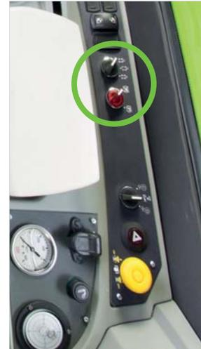
Wahlschalter für Feststellbremse und Wahlschalter für Lenkart.
