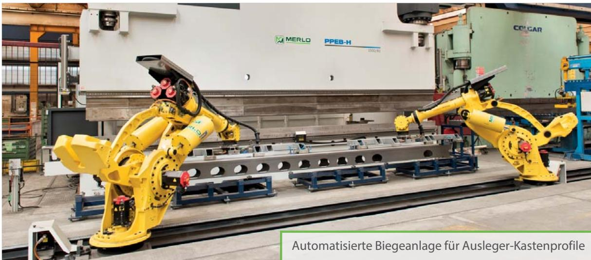
Automatisierte Biegeanlage für Ausleger-Kastenprofile
