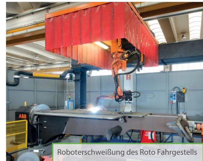
Roboterschweißung des Roto Fahrgestells
