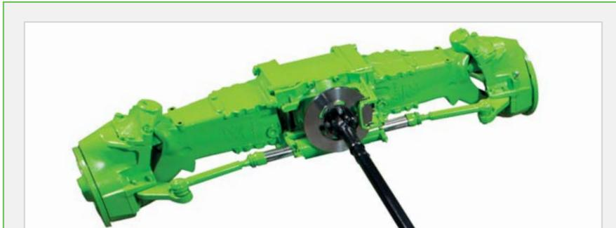
Trockenscheibenbremsen und Feststellbremse. Achsen der Modelle TF38.7 und TF38.10
