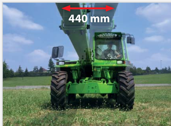
Seitenverschiebung des Oberwagens
