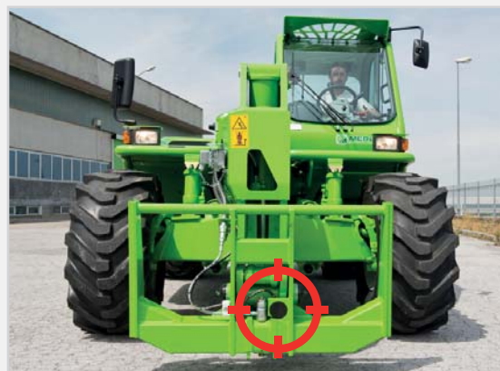
Am Anbaurahmen angebrachter Sensor
