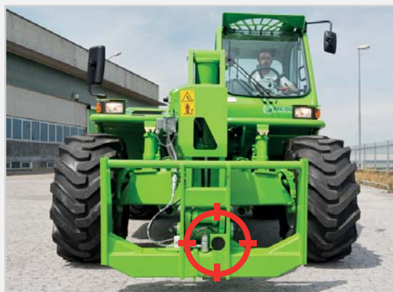
Am Anbaurahmen angebrachter Sensor
