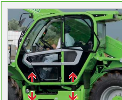
Vom Bediener aktivierbare hydropneumatische Schwingungsdämpfung der Kabine
