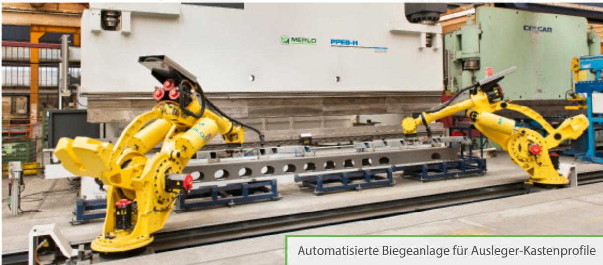
Automatisierte Biegeanlage für Ausleger-Kastenprofile
