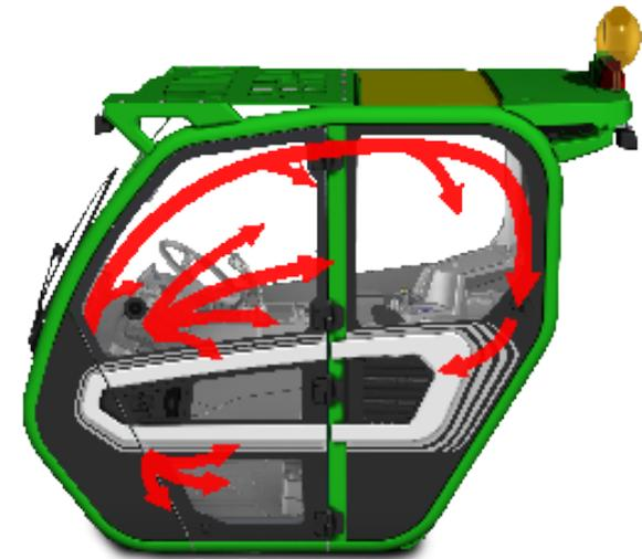
Der Luftfluss ist im Innenraum gleichmäßig verteilt und die Luft gelangt optimal in alle Kabinenbereiche.
