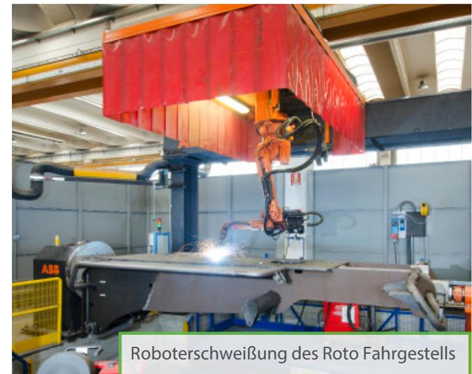
Roboterschweißung des Roto Fahrgestells
